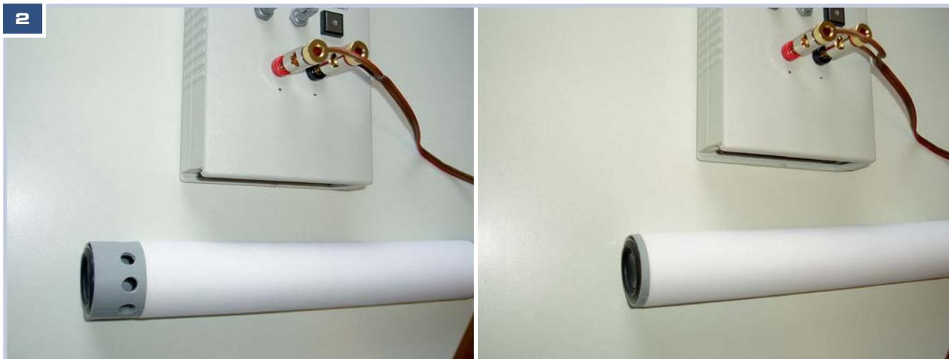
**Bild 2.** Eine Röhre, die den Weg für den Druckausgleich verlängert, kann das nutzbare Spektrum zu niedrigen Frequenzen hin erweitern. Schiebt man sie nach links, sodass sie die Öffnungen am Lautsprecher verschleibt, wird das Klangbild deutlich voller
